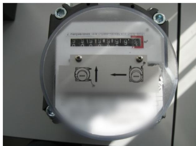
Рисунок 1 — Счетная голова с двумя счетными барабанами
